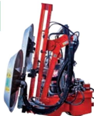
Defogliatrice pneumatica **anteriore** con due testate defoglianti, gruppo compressore posteriore su attacco 3 punti del trattore, 5 movimenti idraulici con joystick elettroidraulico, inclinazione telaio di 30°, cardano, adatta anche per impianti a V-Trellis.
