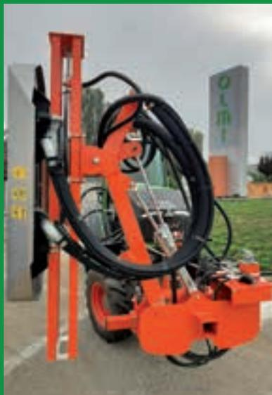
Defogliatrice pneumatica **anteriore** con 1 testata a 4 rotori, gruppo compressore posteriore su attacco a 3 punti del trattore, 3 spostamenti idraulici con joystick elettroidraulico, inclinazione telaio di 30°, cardano.
