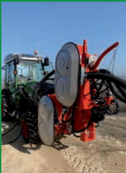
Defogliatrice pneumatica reversibile **anteriore** al trattore con due testate rotazione di 180°, possibilità di ruotare le testate da un lato all'altro, 5 movimenti idraulici con joystick elettroidraulico, cardano.
