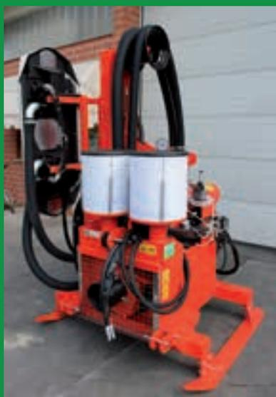
Defogliatrice pneumatica **posteriore**, con 2 testate (4+ 2 rotori) compressore, montata su attacco a 3 punti posteriore del trattore, 3 movimenti idraulici con joystick elettroidraulico, inclinazione telaio di 30°, cardano.
